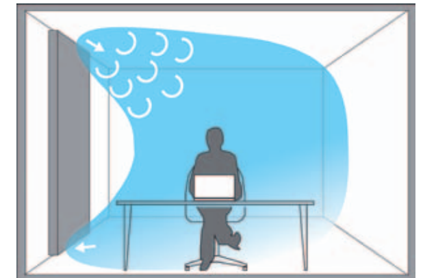
Wandkühlelement mit zugfreier Quellluft (integrierbar z.B. in Wand- oder Akustikelement)
