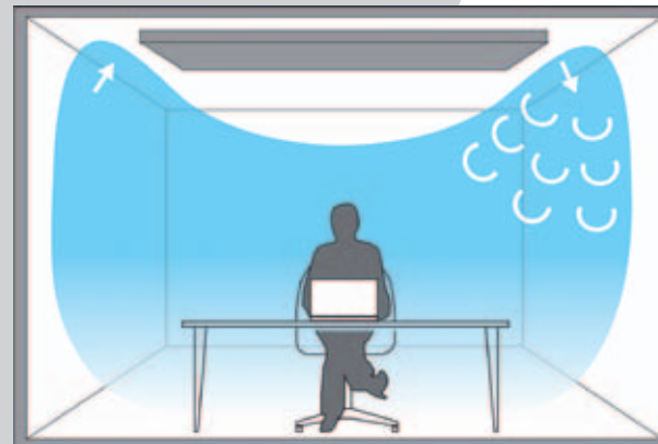
Deckenkühlelement mit zugfreier Quellluft (integrierbar z.B. in Deckensegel oder Abhangdecke)
